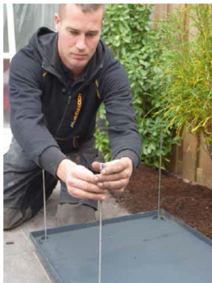
Draai in elke hoek de vier draadeinden in de tapgaatjes van de voetjes.
